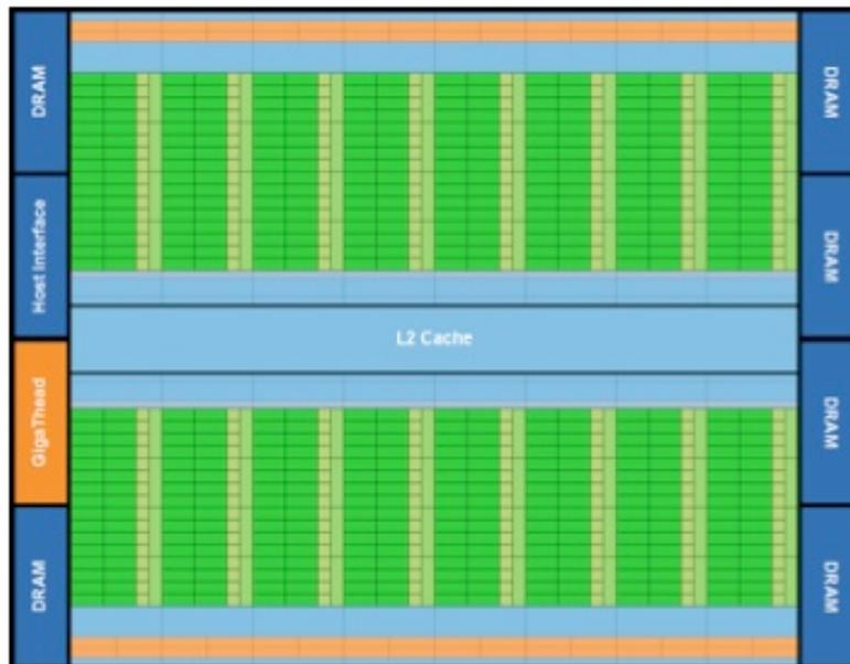
Figura 7.5: visão geral da arquitetura Fermi (fonte: NVIDIA, 2009)
