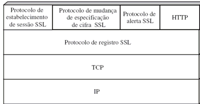
Figura 17.2 Pilha de protocolos SSL.
